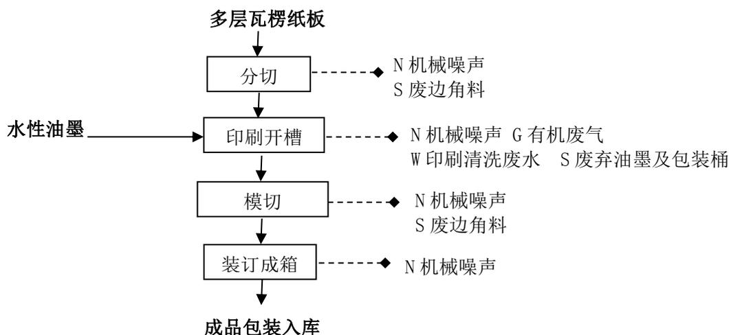
图 2.2-1 本项目生产工艺流程及产污环节框图
