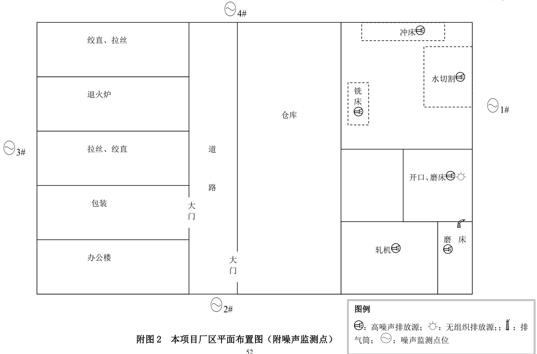
附图 2 本项目厂区平面布置图（附噪声监测点）
