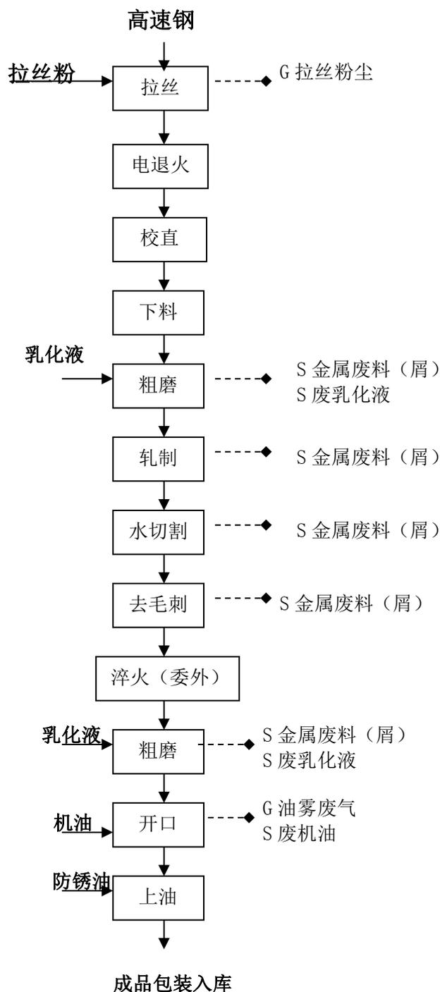
图 2.2-1 本项目钻头生产工艺流程及产污环节图
