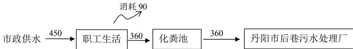
图 1 项目水量平衡图 (单位  $\text{m}^3/\text{a}$ )
