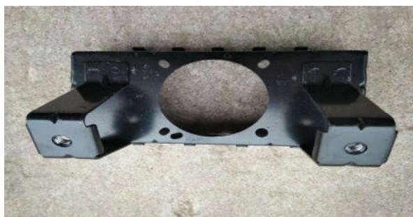
安全气囊是当车辆发生碰撞时,用于检测碰撞加速度信号,控制安全气囊起爆时间的部件,车辆开发过程中要求安全气囊安装支架必须满足一定的固有频率的设计要求,以防止引发共振而产生误起爆。
