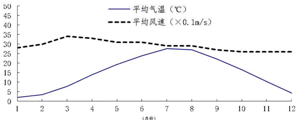
图 2 丹阳市风速、气温年变化曲线
