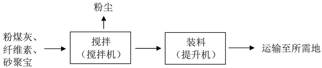
图 1 生产工艺及产污环节图
